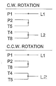
SINGLE VOLTAGE CAPACITOR START CAPACITOR RUN REVERSIBLE
